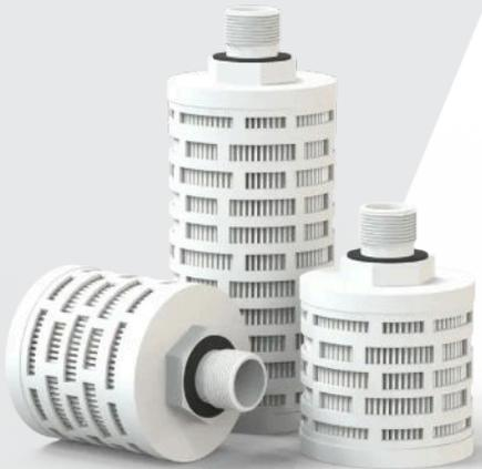
Die ZGP Filterelemente der High Flow Bio-X Vent Serie besitzen einen Außengewindeanschluss und können somit direkt an Behältern/Tanks zur sterilen Be- und Entlüftung befestigt werden. Dieses Filterelement kombiniert die Vorteile der Tiefenfiltration mit der großen Filterfläche eines gefalteten Filterelementes.
